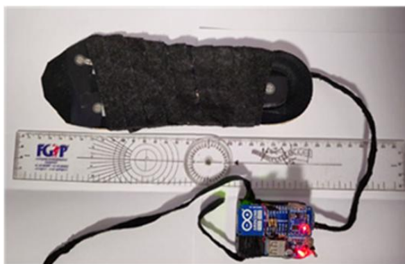
Figura 3.2. Sistem separat de biofeedback vizual în timp real, realizat pe platformă Arduino MKR1000, cu accelerometru ADXL345 și senzori FSR integrați la nivel plantar.
