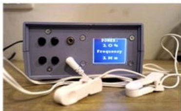
Fig 2 a) Generatorul de semnal cu clipsuri auriculare.
