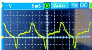
Fig 12. Potențialul de acțiune are o pantă ascendentă de la 0 V la aprox. 0,8 V simulând depolarizarea membranei neuronale, apoi o creștere (vârful de până la aprox. 1,8 V), o pantă descendentă până la 0 V simulând repolarizarea membranei neuronale, apoi o pantă descendentă sub 0 V către -1,5 V, care a fost menită să corespundă hiperpolarizării, ce este urmată de o revenire la 0 V (valoarea potențialului în starea de repaus).
