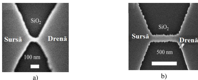
Fig. 3.3. Imagini SEM ale canalelor tranzistorilor fără joncțiune pentru lățimi ale canalului de: a) 100 nm; b) 500 nm.
