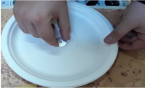
9. Lipiți o șaibă la centrul unei farfurii de carton. Șaiba amortizează mișcarea magnetului, stabilizând mișcarea.
