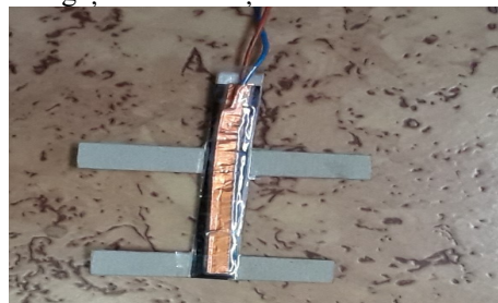
5. Puneți un fir peste banda de Cu și lipiți cu o altă bucată de bandă de Cu.
