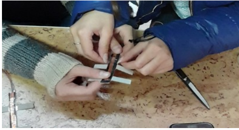
5. Prindeți bine straturile sensorului cu bandă transparentă.
