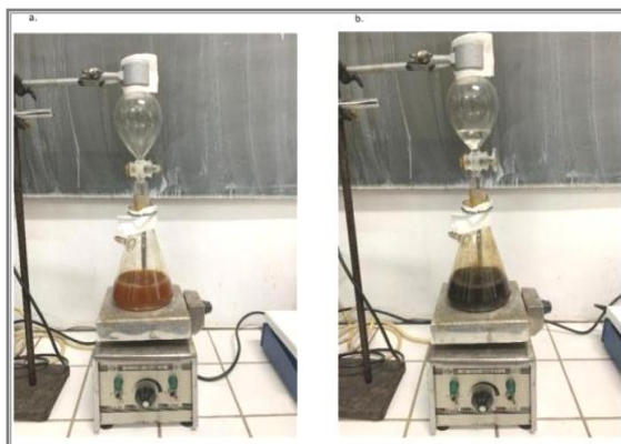
Figura 1.1.1. Sintetizarea nanoparticulelor magnetice: a) soluția rezultată din amestecul de clorură ferică și clorură feroasă în apă distilată ; b) formarea ferofazei (după adăugarea hidroxidului de sodiu).
