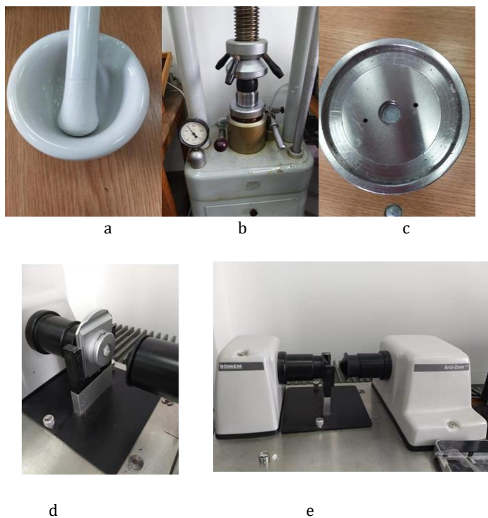
Figura IR5. Pregătirea probei pentru analiză și spectrometrul FTIR: măcinarea amestecului de probă încorporat în KBr în mojar (a), presa pneumatică (b), peletul obținut (c), suportul probei (d), Spectrometrul FT-IR Bomem MB154S cu o rezoluție instrumentală de 4 \text{cm}^{-1} (Bomem, grupul ABB, Canada)
