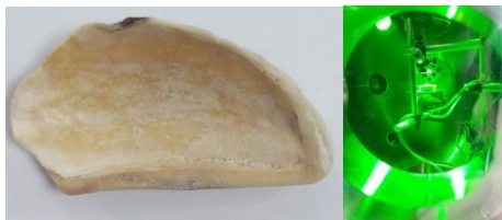
Figura Chit. 1. Ținta din cochilia stridiei (a) și vedere în interiorul camerei de depozitare în timpul ablației cu laser
